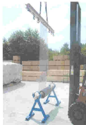
Abwickeln des Metallgewebes (69)
